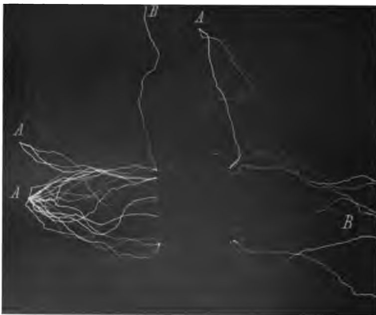
Abb. 364. Gleitfunken (B) und Durchschläge (A) einer Stabilitplatte.
